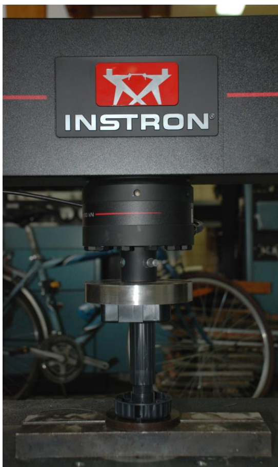
Fot. 1 Sposób badania wytrzymałości na ściskanie nóżek
